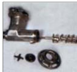
El cabezal, el gusano y la tuerca están contruidos en fierro vaciado con recubrimiento en estaño por inmersión, evitando la corrosión y asegurando la mayor higiene del producto
