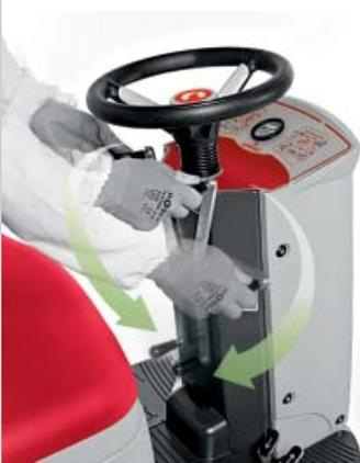
La bancada y la boquilla de aspiración se bajan/levantan simplemente a través de 2 palancas
